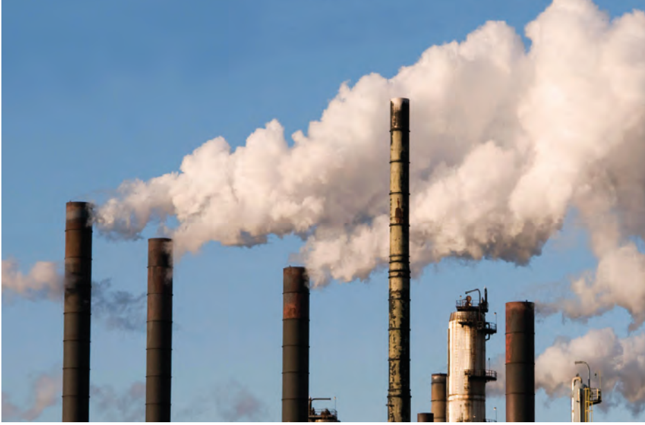
■ الشكل 14-5 الرماد المتصاعد من المداخن نتيجة ثانوية لاحتراق الفحم. ويمكن استعمال مرشحات الترسيب الكهروستاتيكية لتقليل هذا الرماد.
