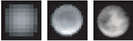
تلسكوب تقليدي تلسكوب هابل الفضائي النظام البصري المتكيف الذي يستخدم
