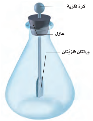
■ الشكل 5-8 الكشاف الكهربائي؛ جهاز يستخدم للكشف عن الشحنات الكهربائية. في الكشاف الكهربائي المتعادل تكون الورقتان معلقتين رأسياً بحرية، وتلامس إحداهما الأخرى.
