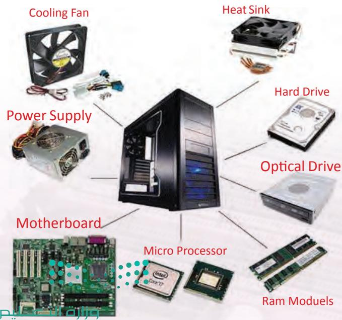
شكل (1-6) نماذج للمكونات المادية التي ستكون موضوع دراسة عمارة الحاسوب في هذه الوحدة الدراسية.
