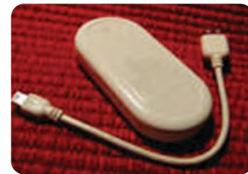
شكل (٩-١) جهاز المودم المرتبط بـ(USB)
