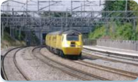
قطار يقيس دقة عمل سكة الحديد
