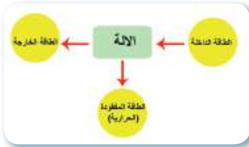
مخطط لتحويلات الطاقة للآلة
