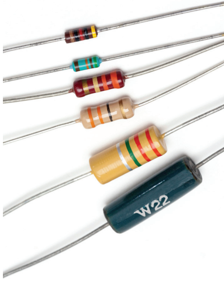
الصورة ٢-٢ مجموعة مختارة من المقاومات الثابتة، بعضها له ترميز من حلقات ملوَّنة للإشارة إلى قيمة مقاومتها، وتستخدم الأخرى ترميزاً رقمياً
